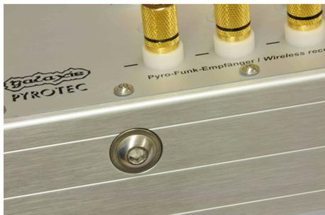
Alle PFE Advanced 10 Outputs, die ab Juni 2010 ausgeliefert worden sind, verfügen über eine Schraube an der rechten Längsseite des Gehäuses. Dahinter befindet sich im Geräteinneren ein Rohr, das mit Trockenmittel befüllt ist. Der Anwender ist dadurch in der Lage, das Trockenmittel leicht selbst auszutauschen. Alle anderen Geräte mit Trockenmittel wurden immer schon mit einer Schraube zum Austausch des Trockenmittels ausgestattet.
